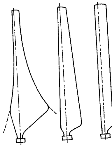
2.35. ábra. Lapátprofilok a sugár (hossz) mentén
