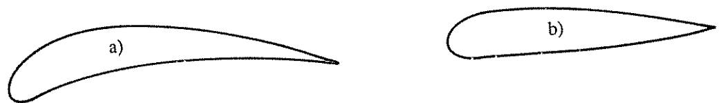
2.32. ábra. A gyors járású szélmotorok szárnylapátai a) ívelt, b) konvex
